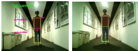
(a)左カメラ（追跡成功） (b)右カメラ（追跡復帰） 図 9 新手法での追跡復帰に成功したフレーム
