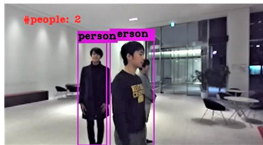
Fig. 1 オクルージョンによる YOLO の失敗例
