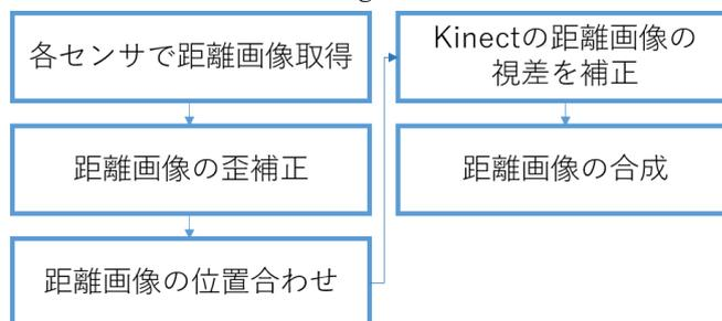
Fig. 2 距離画像作成の流れ
