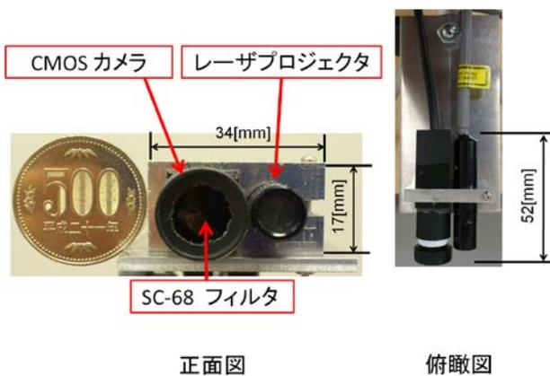
図1 超小型距離画像センサ[1]
